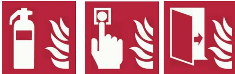
Ejemplos de señalización conforme a la norma UNE 23.033-1:2019
