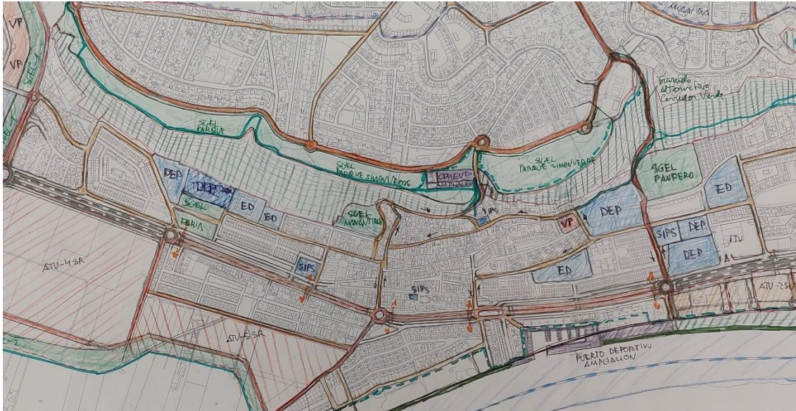
Croquis red viaria Alternativa 1. Reforma en superficie de la travesía de la A-8078.
