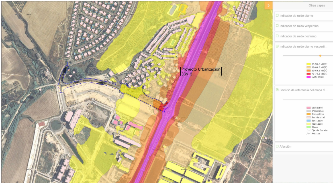
Figura 10.- Esquema de la huella acústica de la A-8058. Fuente: Junta de Andalucía. Consejería de Fomento
